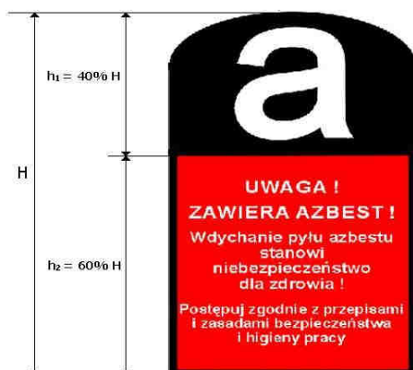
Rysunek 2. Symbol oznaczenia opakowań, odpadów i wyrobów zawierających azbest oraz miejsc ich występowania
